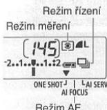
Fotoaparát nabízí režimy poměrového měření, částečného měření a celoplošného měření se zdůrazněným středem. K dispozici máte režimy řízení Po snímcích, Souvislé fotografování a Samospoušť. Zvolte takový režim měření, který nejlépe vyhovuje objektu nebo fotografickému záměru.
