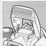
Vestavěný blesk nebo externí blesk Speedlite řady EX pro fotoaparáty EOS umožňuje zábleskové fotografování s automatickým zábleskovým osvětlením E-TTL II (poměrové zábleskové měření s předběžným zábleskem), které je stejně snadné jako normální fotografování. Výsledkem jsou přirozeně vypadající zábleskové fotografie. V režimech základní zóny (kromě <A> <S> <Tv>) je zábleskové fotografování plně automatické. V režimech tvůrčí zóny je možné blesk použít vždy, když je zapotřebí.
