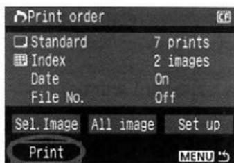
Při použití tiskárny kompatibilní se standardem PictBridge lze snímky snadno vytisknout pomocí formátu DPOF.
