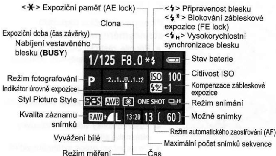
Pokud stisknete tlačítko <ISO->, <AF-DRIVE>, <WB->, nebo <->, zobrazí se obrazovka nastavení a otáčením voliče <> nebo <> můžete vybrat požadované nastavení. Je také možné vybrat bod AF pomocí voliče <>.
