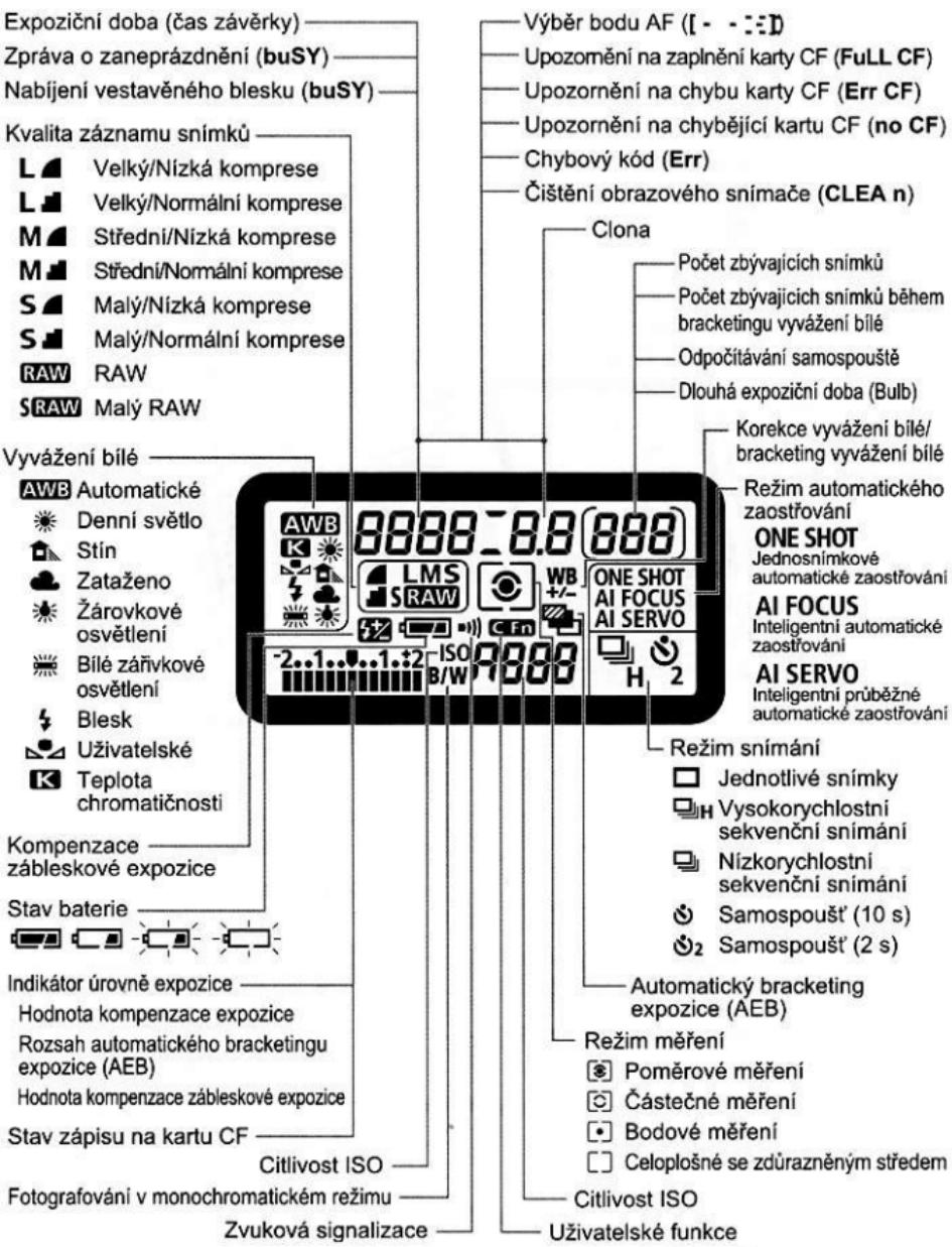
Na displeji se zobrazí pouze nastavení, která jsou aktuálně použita.
