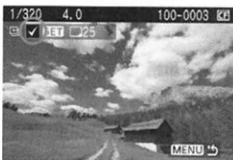
Slouží k výběru a označení snímků po jednom. Stisknutím tlačítka <SET> zahrnete zobrazený snímek do snímků označených k přenosu. Vlevo nahoře se také zobrazí ikona <✓>. Po dokončení označování snímků k přenosu je uložte stisknutím tlačítka <MENU> na kartu CF.
